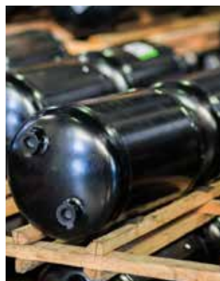
Reservatórios de Ar
